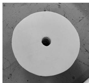
9. Corta un círculo de Styrofoam rígido de 1 cm. (½") como separador. Corta un orificio de 1 cm. (½") en el centro para insertar el caño corto.
