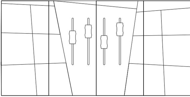
3. Levanta los paneles 2 y 3 y colócalos uno junto al otro. Comprueba el trazado de las líneas para que coincidan de un panel a otro y haz los ajustes que sean necesarios.
