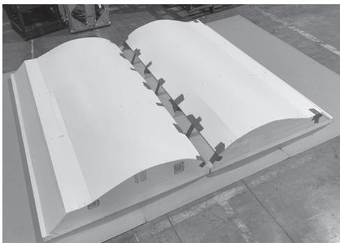
de otra persona para alinear una página de Coroplast en las esquinas exteriores superior e inferior. Luego, lenta y cuidadosamente, doblen el Coroplast para darle la forma de los soportes. Utilicen alfileres T y cinta de pintor para mantener el Coroplast en el lugar, mientras el pegamento se seca hasta el día siguiente. Repitan el procedimiento con el otro lado.
