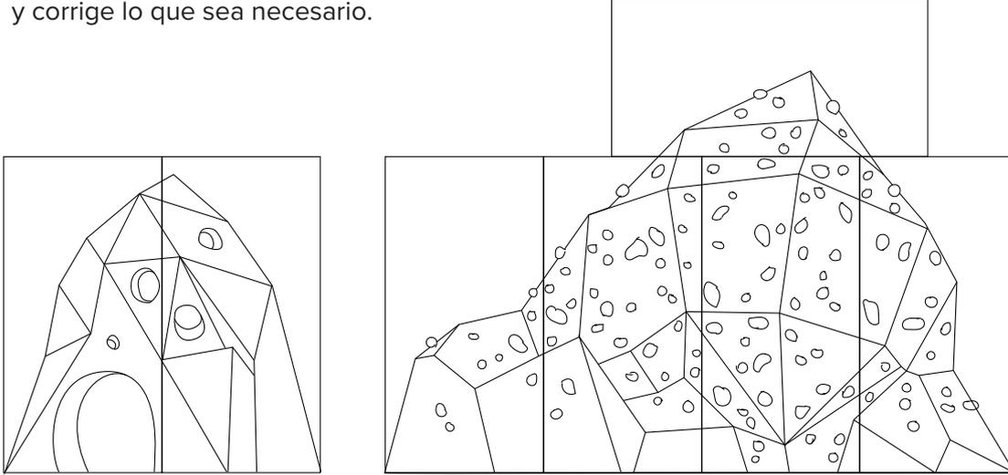
3. Corta los muros de escalada con un serrucho. Comprueba que las líneas coincidan después de cortar cada panel. Corta la abertura central en el muro más pequeño.
